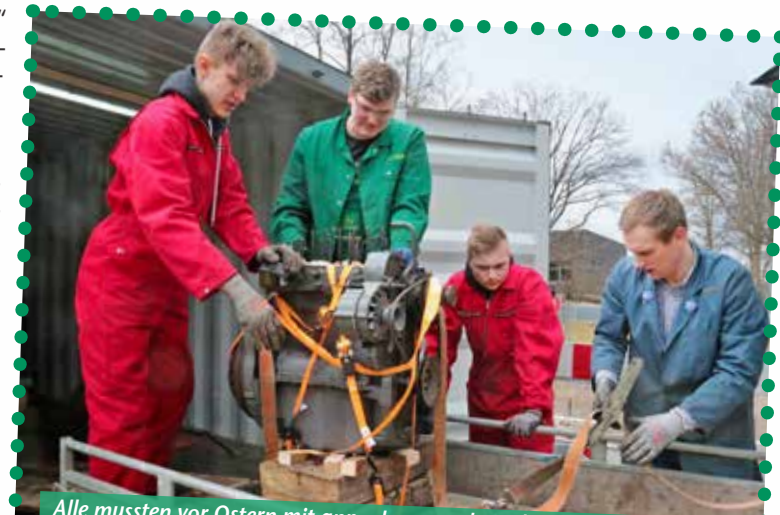
Alle mussten vor Ostern mit anpacken, um den schweren Motorblock auf den Anhänger zu wuchten. Beim Landmaschinenhändler sollen Zylinderkolben und Laufbox ausgetauscht werden, weil der Motor zu viel Öl verbraucht. V. li.: Julian Bürger, Azubi Jesse Lutterbeck, Maurice Poggensee und Lehrer Timo Möller.
