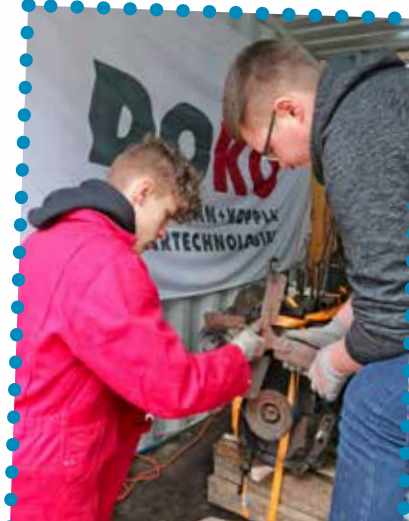
Julian (li.) schraubt das Lüfterrad ab, damit der Motorblock einfacher transportiert werden kann. Malte hilft ihm dabei.
